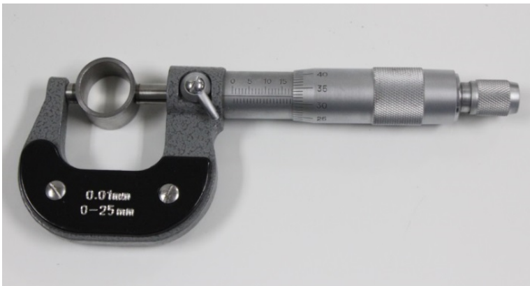
Figure 9 : Mesure de la déformation de l’anneau dynamométrique.
