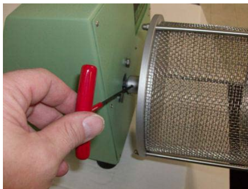
Рисунок 3: Затягивание болтов с помощью шестигранника
