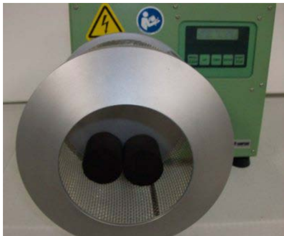
Рисунок 5: Образцы помещены во вращающийся барабан
