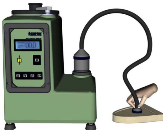
Figure 5.5.3: Exemple d'éprouvette et démarrage de l'appareil
