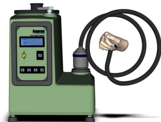
Figure 5.5.1 - Boucher à la main la tête de mesure de l'accessoire
