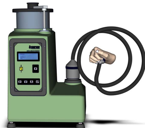
Figure 5.5.2: Cylindre gazométrique montant à sa hauteur maximum
