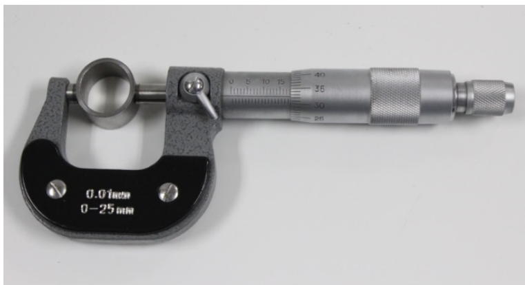
图9：显示了校验环变形量的测量。
