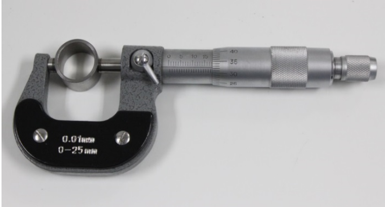
Figure 9 : Mesure de la déformation de l'anneau dynamométrique.
