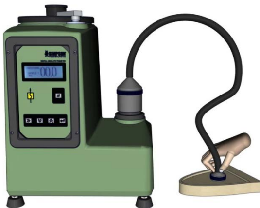
Рисунок 5.5.3: Приставка измерения газопроницаемости форм приставлена к образцу, прибора измерения проникаемости включается
