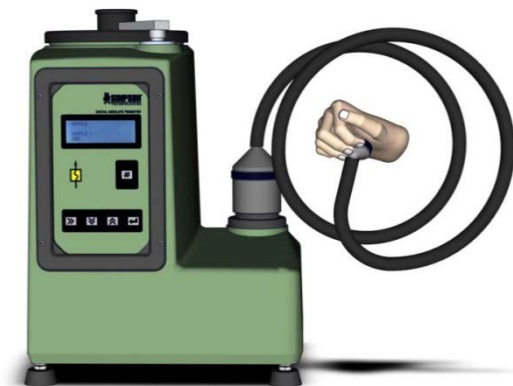
Рисунок 5.5.1 – Приставка для измерения газопроницаемости форм зажата рукой
