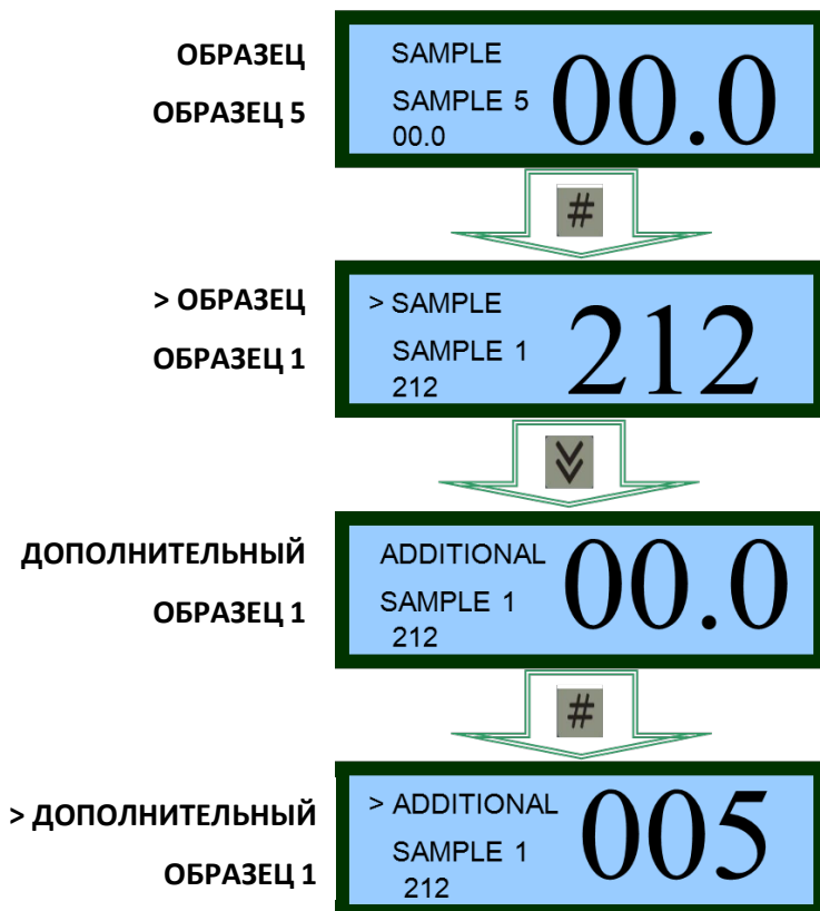
График 5: Показан порядок операций при использовании прибора определения проникаемости с 42105D
