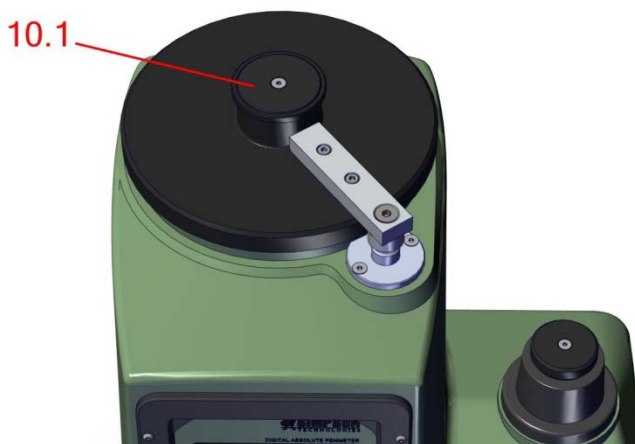
Рисунок 10: Верхняя часть колокола (поз. 10) с емкостью калибровочного веса (поз. 10.1)
